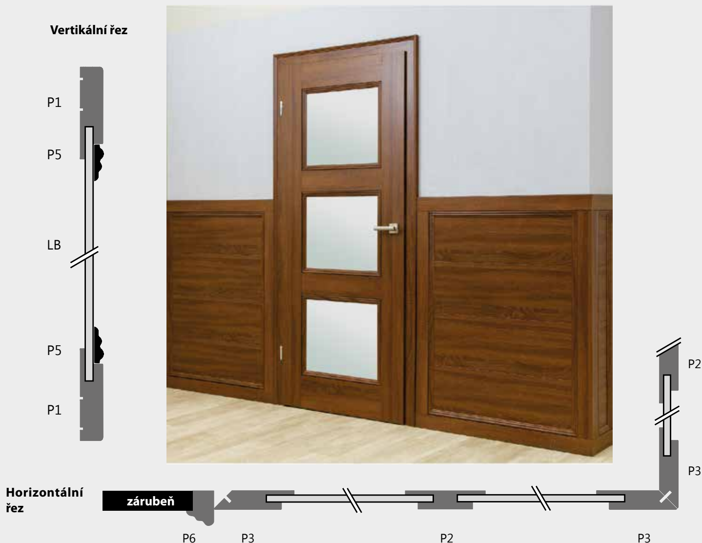
Schéma provedení rohového obkladu stěny
